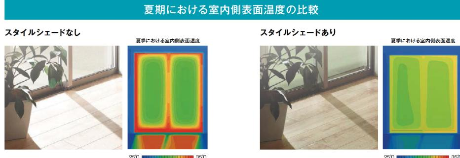
夏季における室内側表面温度の比較 ■ 温度条件:室内25°C、室外30°C ■ 日射条件:東京 真夏 晴天の西日 ■ 使用ソフト:STREAM V9
